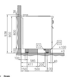
Electrical inlet (power) ΕI Equipotential screw Water inlet
